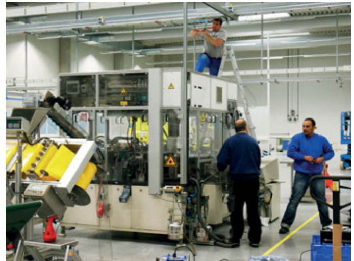
Der Montage-Vollautomat CUNO wird in Betrieb genommen.
