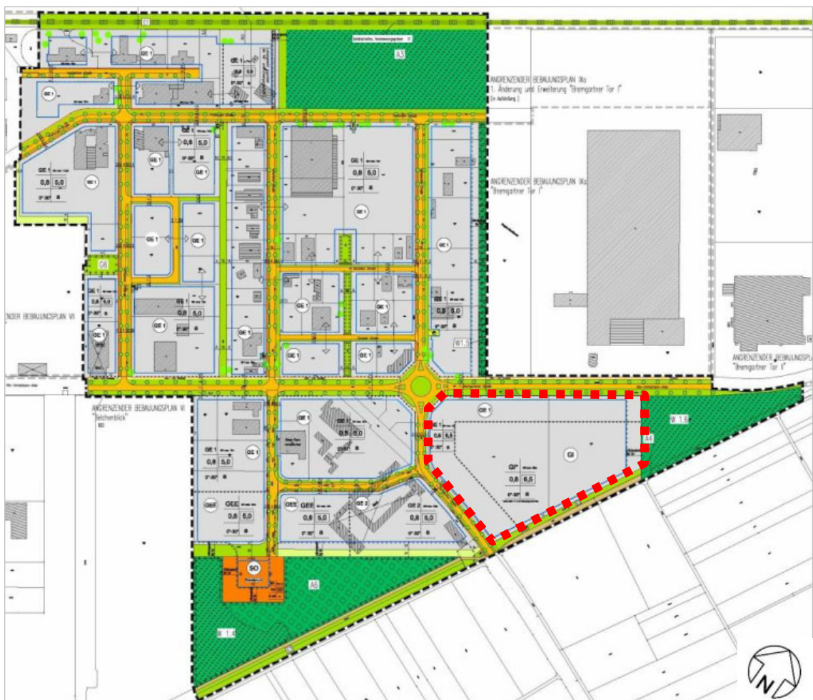
Übersicht Planzeichnung Bebauungsplan I „Eschbacher Tor“ in der Fassung der 2. Änderung und Neufassung mit Darstellung des Änderungsbereichs (rote Strichellinie) (Stand: Rechtskraft seit 23.09.2015; nicht genordet; ohne Maßstab)
